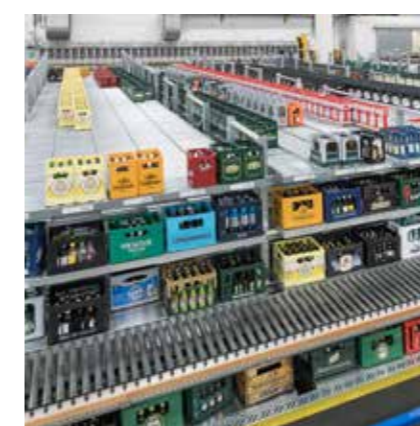
Lagerung der B- und C-Artikel in den Sortierkanälen
